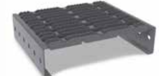
DRAINSTEP RH3 Über 70% offener Querschnitt für maximale Drainagewirkung, stellt erhöhten Durchfallschutz sicher, steil aufgestellte Stege sorgen für eine hervorragende Quersteifigkeit
